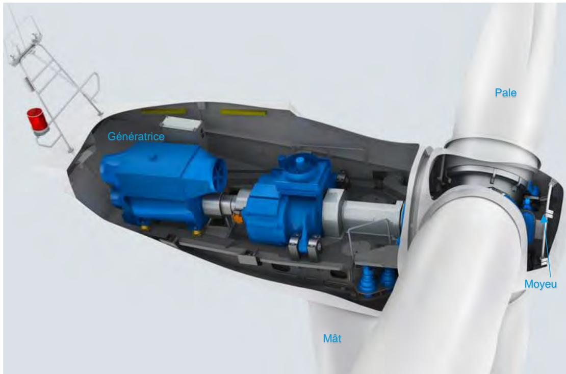
Figure 4 : Schémas d'une nacelle – Source : Senvion
