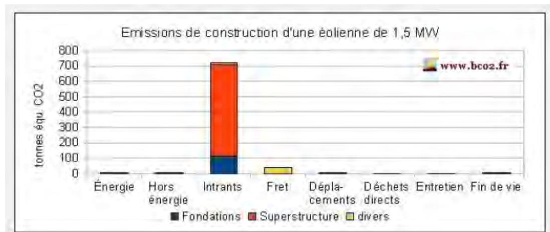
Figure 9 : Bilan carbone de l'énergie éolienne - Source : BCO2 ingénierie
